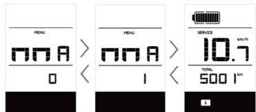
**HINWEIS:** Bei aktivierter Funktion „Service Tip“ erscheint im eingeschalteten Zustand nach jeweils 5000 km zurückgelegter Strecke (Strecke von mehr als 5000 km) die Anzeige **„SERVICE“**.
